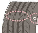
スリップサインが出た状態
